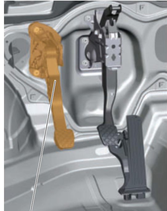
Kupplungspedal mit Geber für Kupplungsposition
